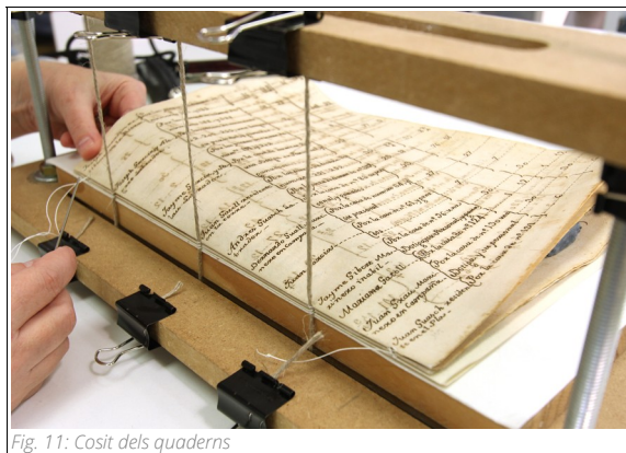
Fig. 11: Cosit dels quaderns
