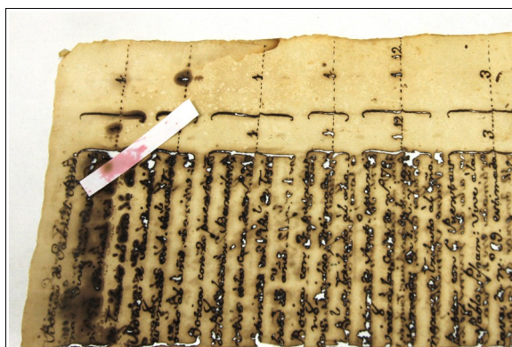
Fig. 8: Test de betofenantrolina
